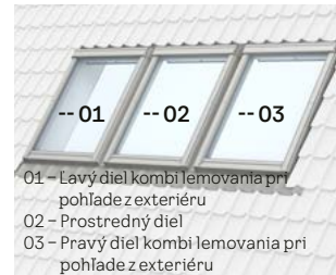
Trojica strešných okien vedľa seba s krokvmi
